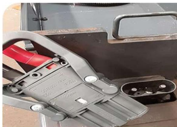
**02** Conecte o plugue de descarga da bateria ao plugue do equipamento.
